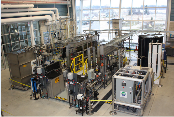
Le CWAE a utilisé son usine pilote conventionnelle à train double pour comparer les doses de produits chimiques.
