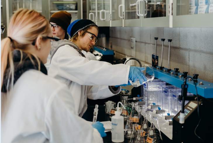
Expériences d'essais de floculation pour l'optimisation du traitement conventionnel dans le laboratoire du CWAE
